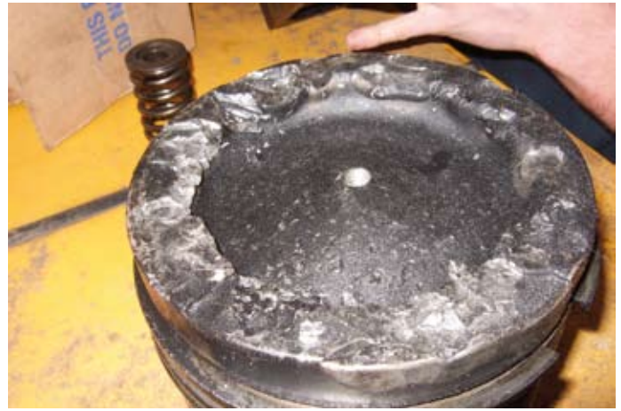
Een beschadigde zuigerkop door een losse klep.
